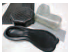
繊維強化熱可塑性樹脂基複合材料とそのダイヤフラム成形品
