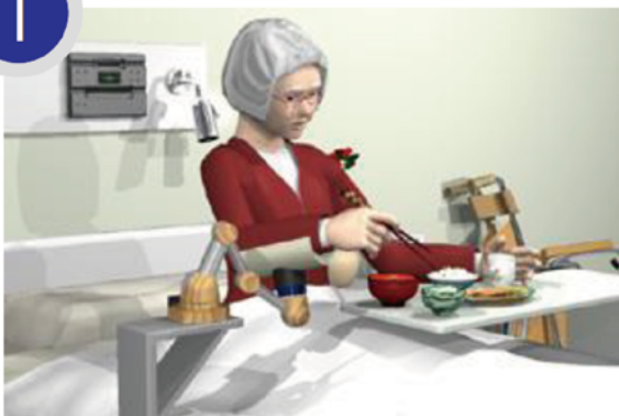
上肢補助アシストロボット [Human motion Assisting Robot Manipulator ; HARMony (ハーモニー)] と実験風景
