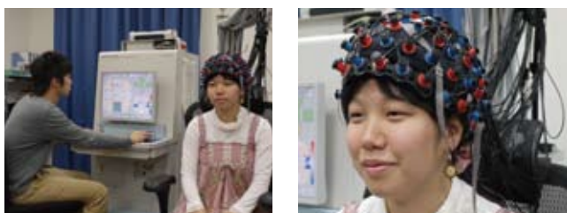
近赤外線を照射して脳機能を測定する光トポグラフィー
